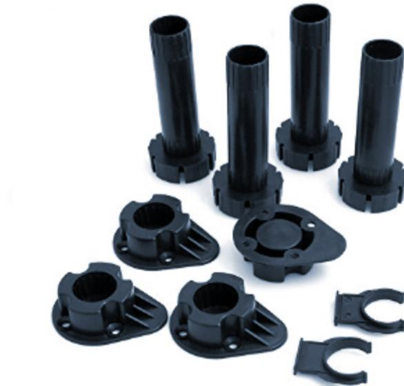
**PATAS DE PLASTICO.** A los muebles bajos se les añaden unas patas de plástico que los cargan y separan del piso, esto suele forrarse con una tapa de MDF o de Aluminio y sellarse con silicón para evitar en la medida de lo posible que el polvo o la suciedad se introduzca debajo de los muebles ya que se genera un hueco en la parte baja. Esta es una solución alternativa en caso de que por cuestiones de la vivienda la instalación de un poyo de material pétreo sea inviable.
